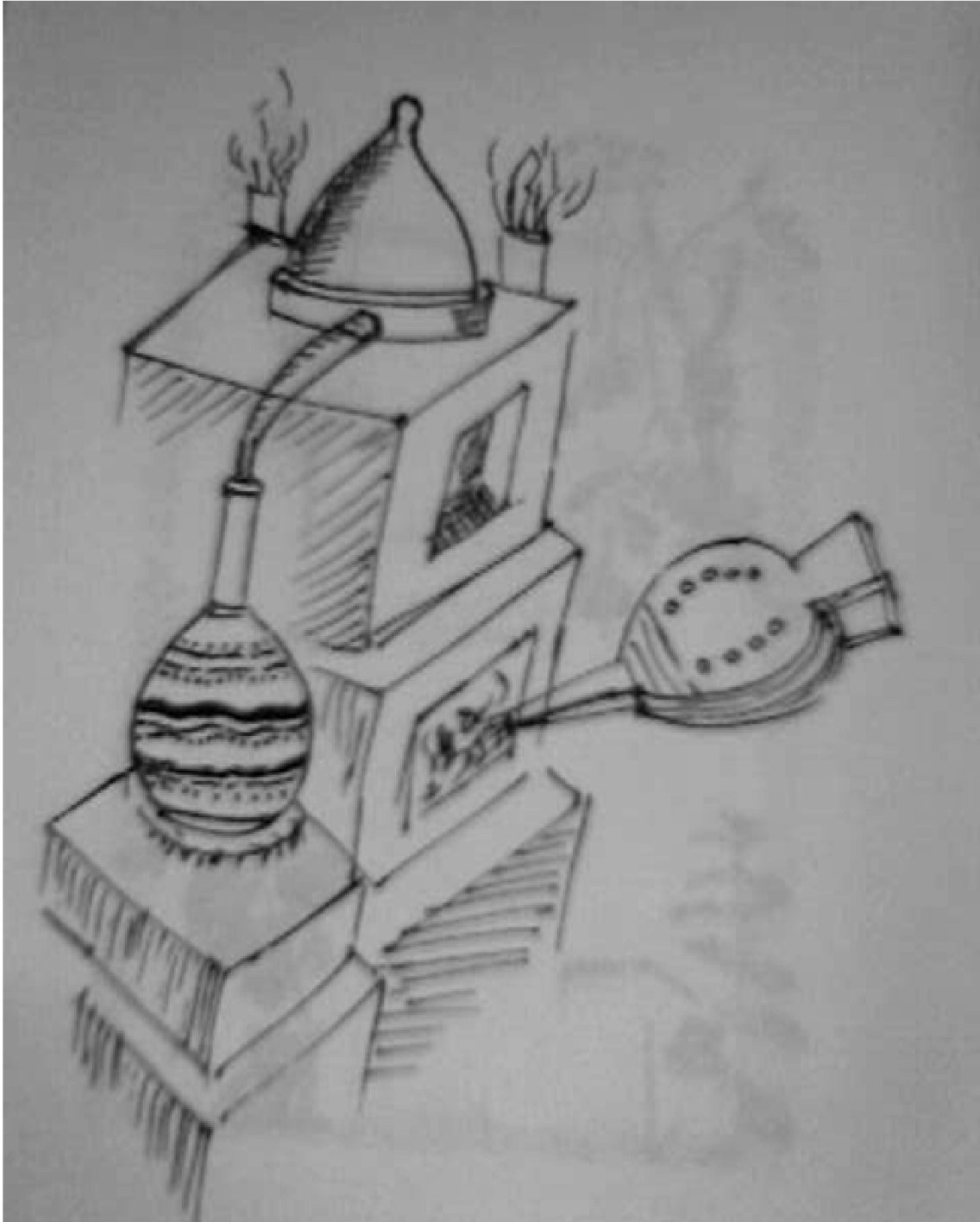
الشكل رقم ( ٣٥ ) صورة لفرن استخدمه العلماء العرب وهي مأخوذة من كتاب الكيمياء عند العرب لجابر شكري ، صفحة ٦٨
